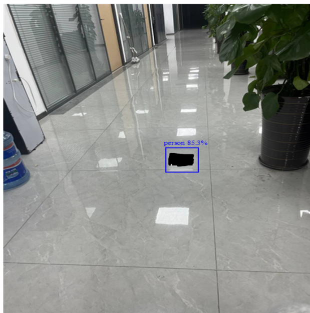
图 3-14 YOLOv8 误检测
