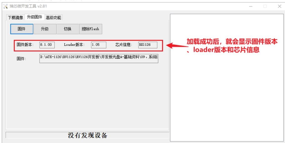
图 3.8.3 成功加载固件
