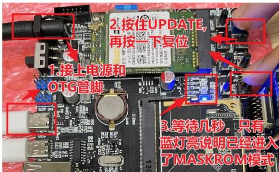
图 3.7.2.3 ATK-DLRV1126 MASKROM 烧录连接图
